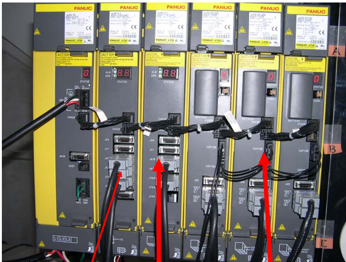
主轴指令线，接系统的 JA7A， 伺服指令线（光缆），连接到系统轴卡的 COP10A。
